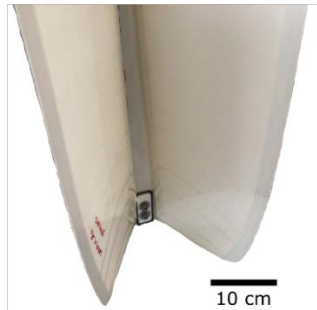
Abb. 22: Detailansicht der bionischen Fassadenverschattung Flectofin® bestehend aus zwei offenen Lamellen.
