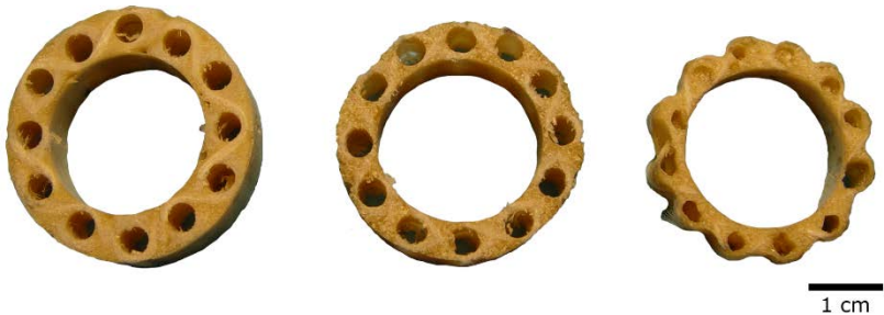
Abb. 16: „Technischer Pflanzenhalm“ in verschiedenen Ausführungen (Einfach- oder Doppelgeflecht, kreisrunder oder sternförmig gelappter Umriss)
