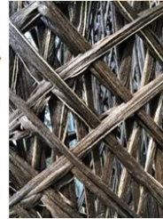
Verwendung von Flachsfasern und Sisalschnüren im bioinspirierten Tragwerksystem: Nachwachsende, gut recycelbare Rohstoffe → bessere Ökobilanz
